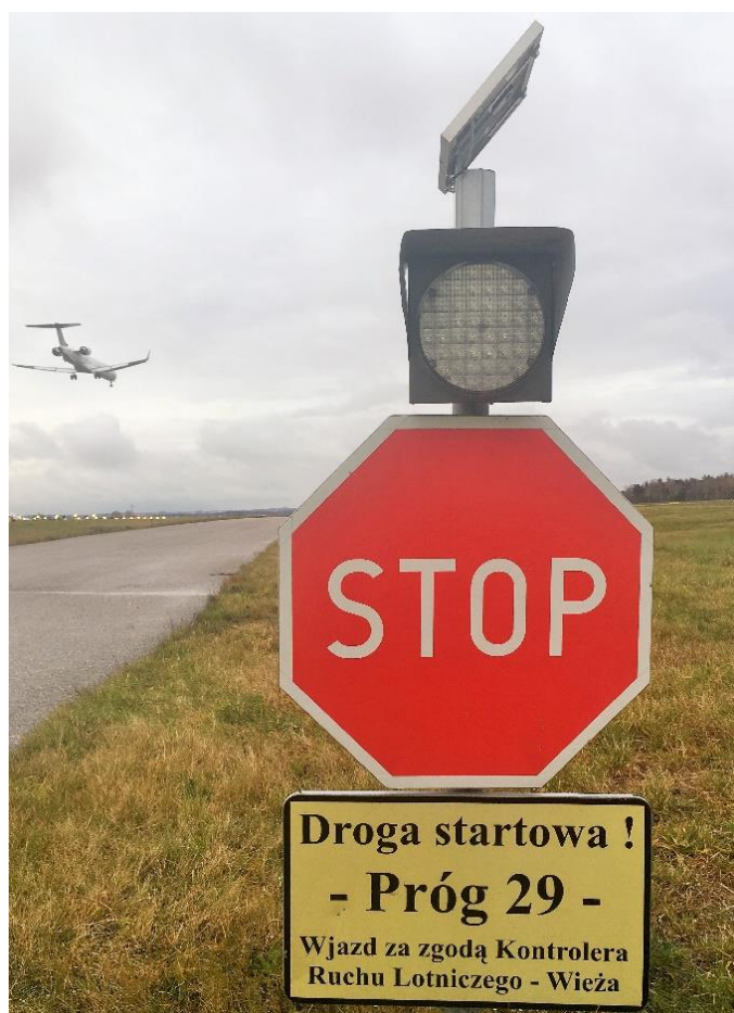
Znak i oznakowanie miejsca oczekiwania na drodze ruchu kołowego przed drogą startową.
